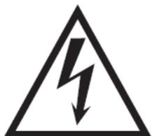
Il simbolo del fulmine all'interno del triangolo ha lo scopo di avvisare l'utente di una tensione pericolosa non isolata nell'involucro posteriore del prodotto che potrebbe raggiungere un livello tale da comportare seri rischi di scosse elettriche.
